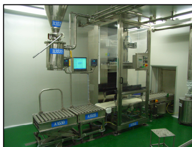
带自动电子称和封装功能的人工灌装站，提供高操作效率的同时保证了低成本的优势
